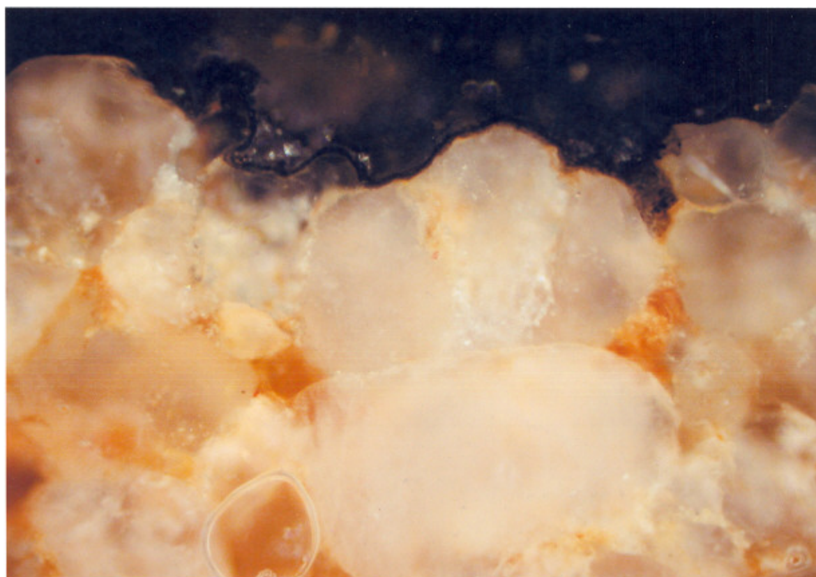
vzorek V2: fotografie z optického mikroskopu ukazuje vrstvu nečistot na zrnech křemene. Povrch je pokrytý kompaktní vrstvou silikátového filmu, který částečně vyplňuje i prostor mezi zrnky.
